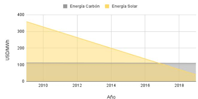
Figura 3. Costo nivelado de Generación Eléctrica de la energía solar y energía proveniente de plantas eléctricas basadas en carbón del año 2009-2019, dólar por Mega Watt por hora.
